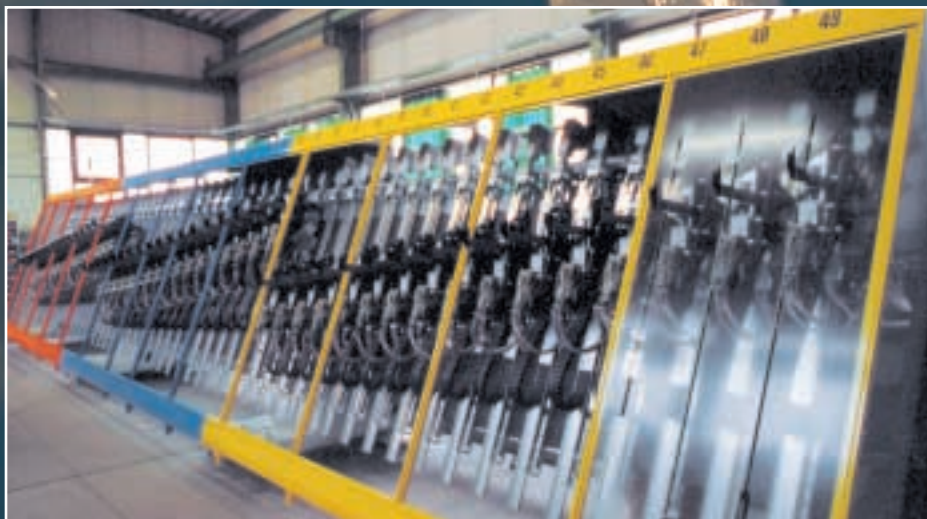
Gesamtansicht der neuen Messmaschine. Sie ist rund 12 Meter lang und verknüpft 49 Messachsen
