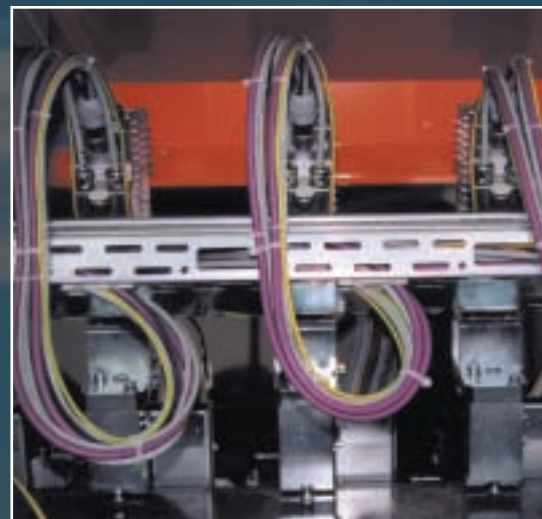
Die Posmo A-Motoren werden direkt am Profibus DP betrieben. Für den Anwender heißt das wenig Verkabelungsaufwand
